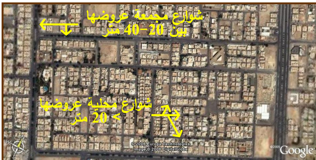
الشكل رقم(2) صورة جوية توضح استقامة واستطالة الشوارع في الأحياء السكنية واتساعها.
