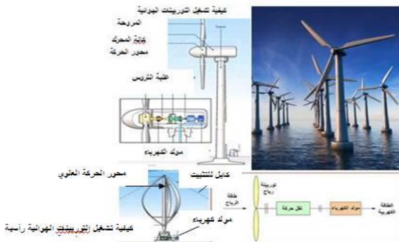
شكل رقم (8): يوضح فكرة عمل توربينات الرياح ذات المحاور الرأسية والأفقية [23]
