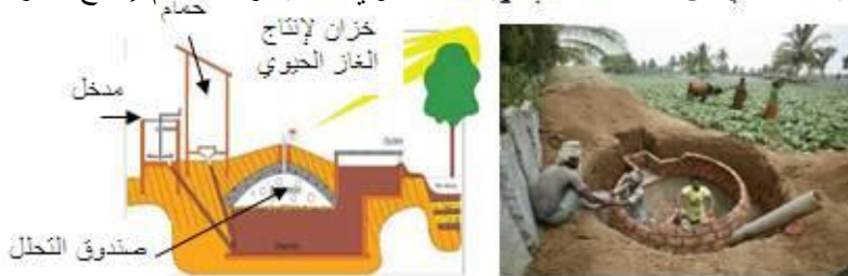
شكل رقم (10): خزان تحليل للتخلص من المخلفات العضوية بأحد القرى الهندية والمستخدم لإنتاج الغاز الحيوي، [4]
