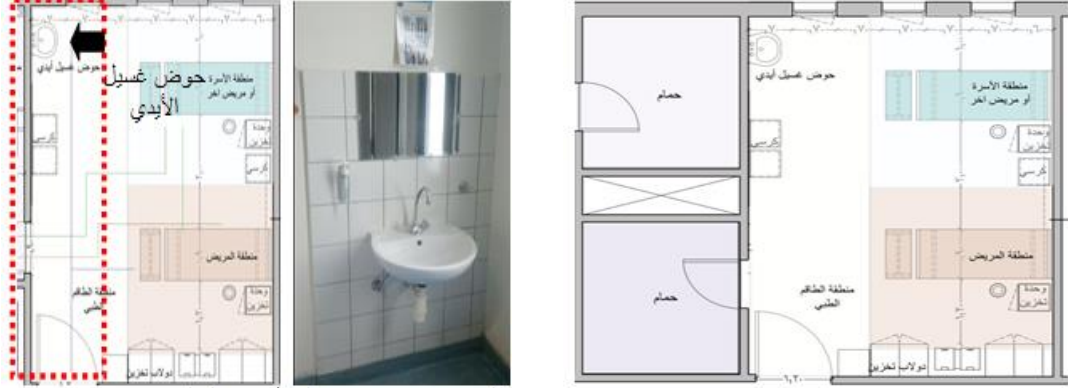
(شكل 25): موقع حوض غسيل الأيدي داخل الغرفة 44
