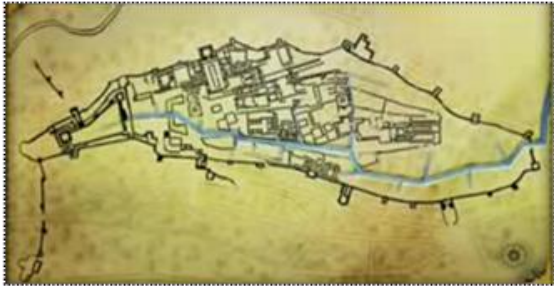
شكل (٣-١٣): اسكتش يوضح مسارات حركة المياه داخل القنوات في الحمراء
