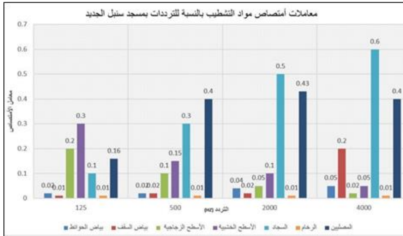
شكل رقم (٧): رسم بياني يوضح معاملات الأمتصاص لمواد التشطيب بالنسبة للترددات بمسجد سنبل الجديد [5.12] (المصدر: الباحث)
