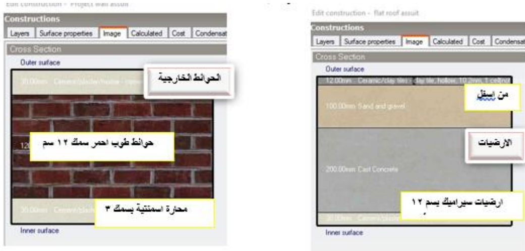
شكل رقم (٤) صورة من البرنامج توضح طبقات الحوائط والسقف ومكوناته
