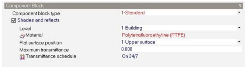
شكل (٣٨) يوضح الخامة المكونة للمظلة المقترحة للمبني من البرنامج design builder
