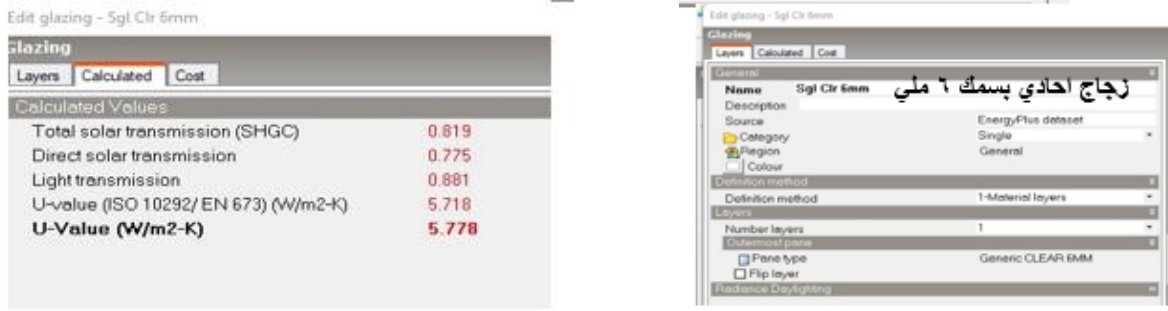
شكل (٢٧) يوضح مساحة الفتحات النوافذ ونوع الزجاج وخامة النافذة
